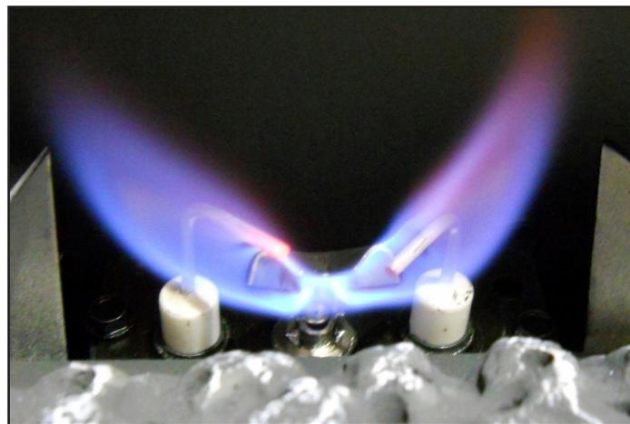
Figure 4.3 Forme de flamme de la veilleuse IPI
