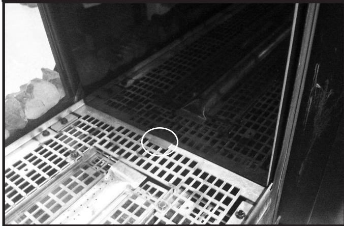
Figure 10.8 Position du clip de vitre et installation du panneau de verre
