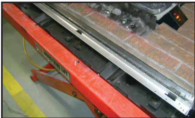
Figure 11.5 Onglets inférieurs de verrouillage installés dans le cadre de la vitre
