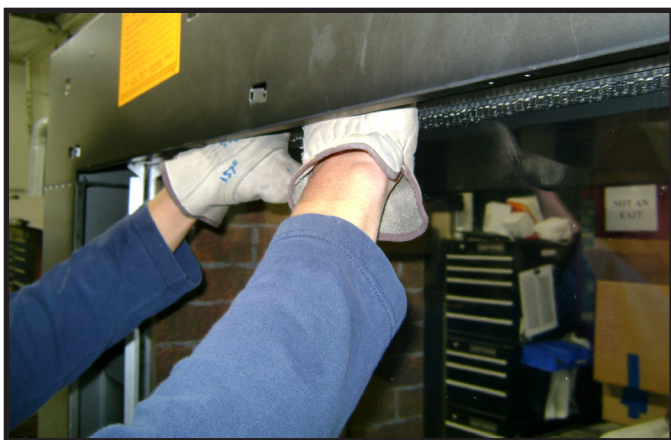
Figure 11.6 Accès à l'onglet supérieur de verrouillage
