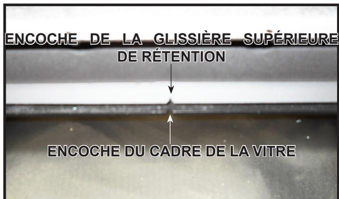
Figure 11.5 Alignement des encoches
