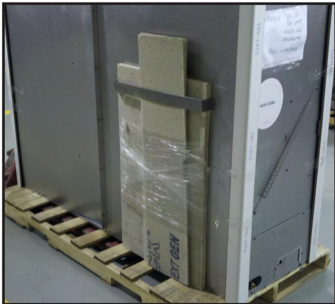
Voir la figure 6.6. Emplacement de transport des panneaux incombustibles
