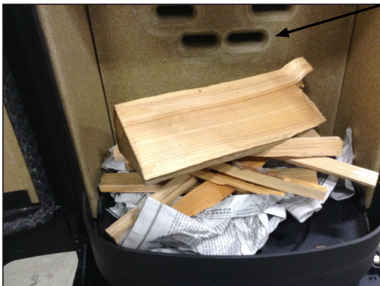
Fig. 11.3: Legg til en større kubbe oppå haugen og pass på at den ikke rekker over øvre inntakshull.
