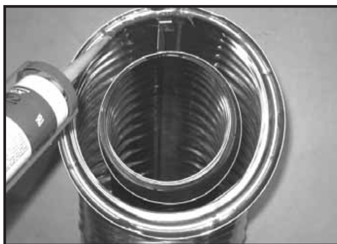
Abbildung 10.2 Dichtung aus temperaturbeständigem Silikon
