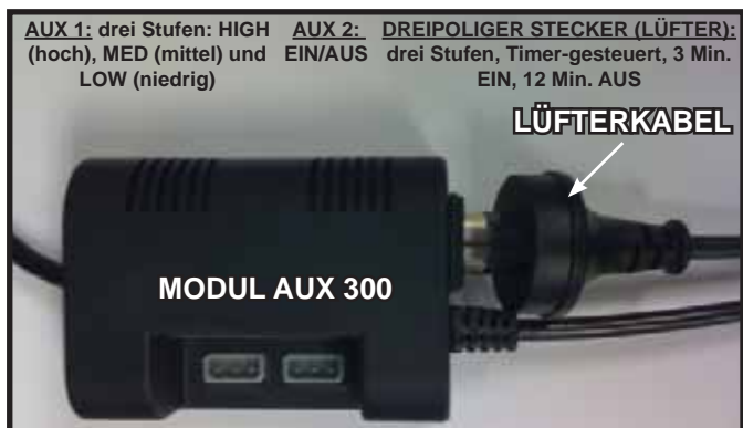
Abbildung 12.10 Anschließen des Lüfters an das Modul AUX300CE
