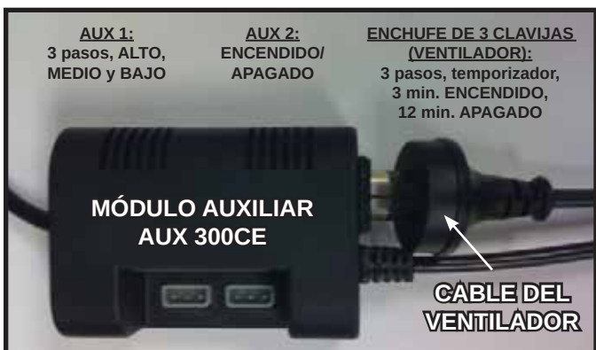
Figura 12.9 Enchufe el ventilador en el módulo AUX300CE
