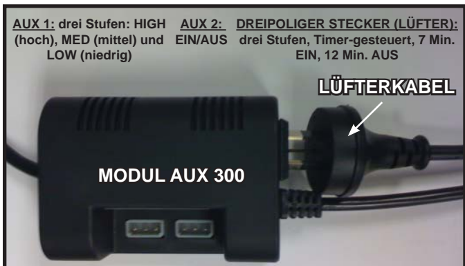
Abbildung 12.10 Anschließen des Lüfters an das Modul AUX300CE
