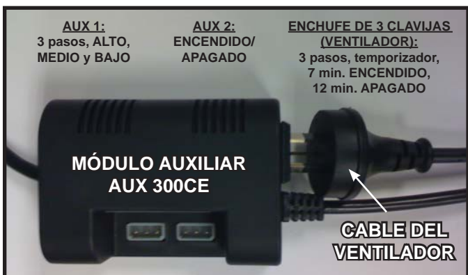
Figura 12.10 Enchufe el ventilador en el módulo AUX300CE
