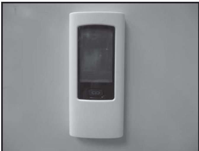
Fig. 12.8 Montering av holder til fjernkontroll
