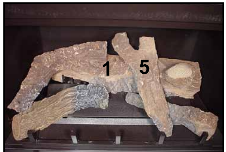
KUBBE NR. 5 (SRV438-724): Legg oversiden av kubbe nr. 5 på kubbe nr. 1 og plasser undersiden på høyre siden av risten til kubbe nr. 4.
