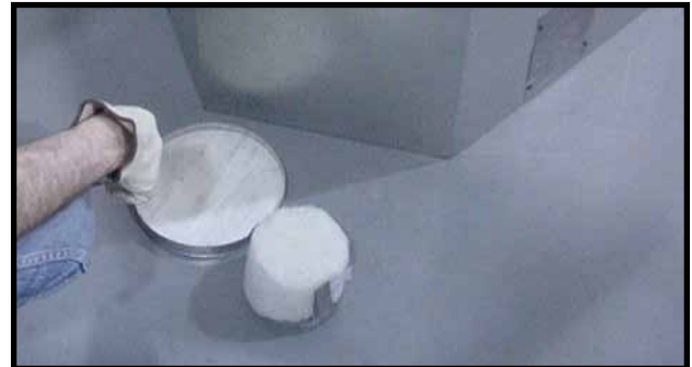
Figur 26. Kast avtrekksketten. Fjern og kast isolasjonskurven. Merk: Når avtrekksketten er fjernet, kan den IKKE settes på igjen.
