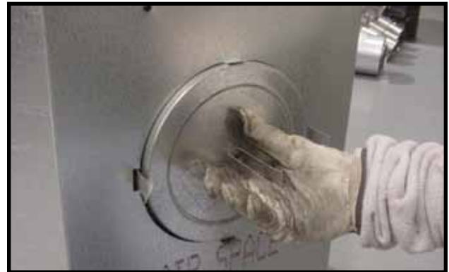
Figur 25. Bøy de midtre delene av båndet utover og bruk dem til å fjerne avtrekksketten.
