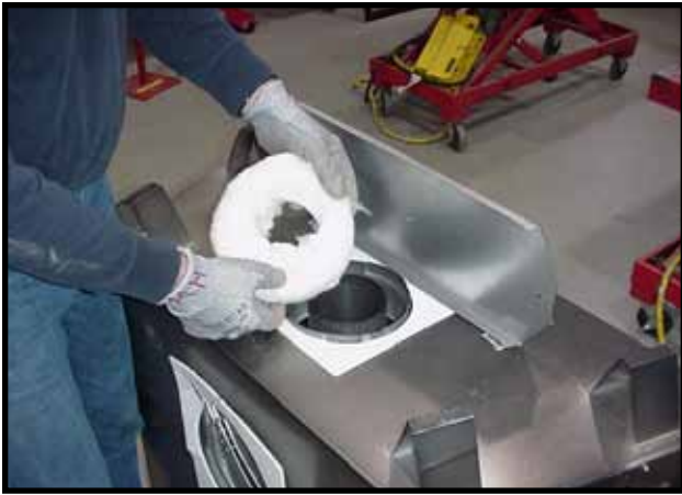
Figur 21. Fjern isolasjonen fra det ytre avtrekksrøret.
