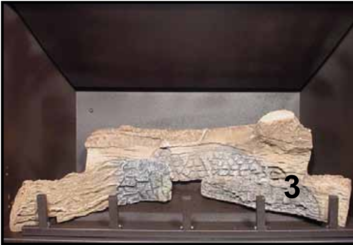
KUBBE NR. 3 (SRV705-703): Legg kubbe nr. 3 mot fremre hjørnet av brenselristen og plasser sporet over brennerens høyre spiss.
