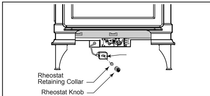
**Figure 15** - Attach the fan rheostat.
