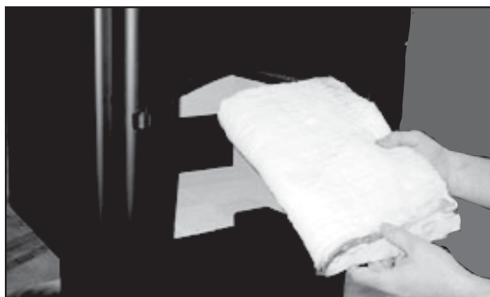
Figure 26.2 - Laine céramique isolante
